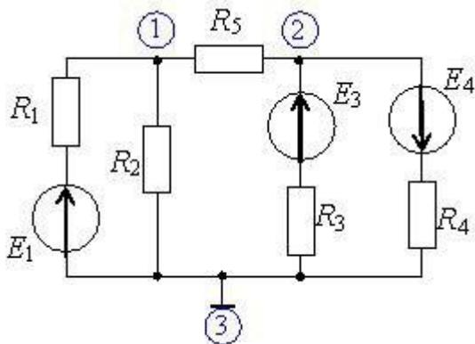
A.  $-\varphi_1 \frac{1}{R_5} + \varphi_2 \left( \frac{1}{R_3} + \frac{1}{R_4} + \frac{1}{R_5} \right) = \frac{E_3}{R_3} + \frac{E_4}{R_4}$
